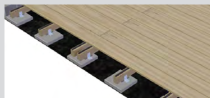
Ausführung von Längsstößen zwischen zwei Auflagern
